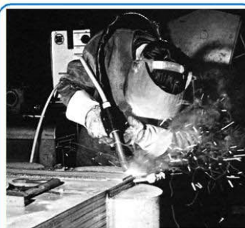
Sumber: Ilmu Pengetahuan Populer Gambar 7.10 Gas asetilena dimanfaatkan untuk mengelas besi dan baja
