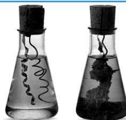
Gambar 6.4 Reaksi tembaga dalam larutan \text{AgNO}_3
