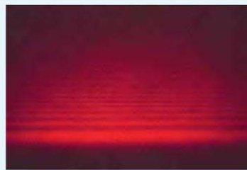
Gambar 4.7 Difraksi dari sinar laser He-Ne yang dikenakan sebuah ujung benda sebagai penghalang. Gambar diambil 4m dari ujung benda.
