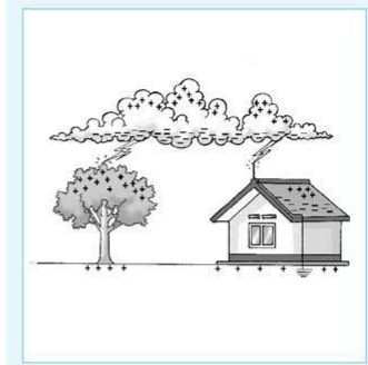
Gambar 5.16 Kilat polarisasi muatan pada awan menginduksi muatan terhadap permukaan bumi melewati benda-benda yang
