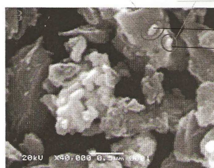
Foto SEM dari sampel ZnO A (T=500° C)
